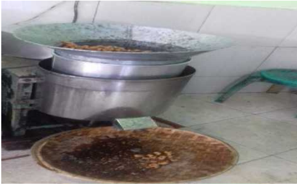
Pengeringan minyak goreng dari jambu mete dengan menggunakan mesin spiner
